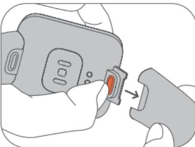
**Instalar a bracelete:** alinhe o encaixe da bracelete com o smartwatch e, em seguida, insira-o no smartwatch até ouvir um clique.
