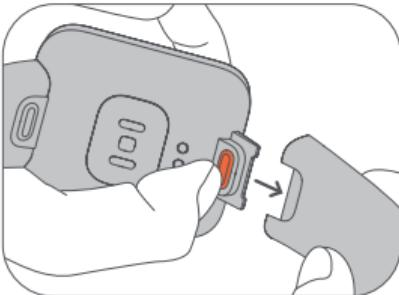
**Anlegen des Riemens:** Richten Sie den Schlitz am Riemen auf die Uhr und schieben Sie den Riemen dann hinein, bis Sie ein Klicken hören.
