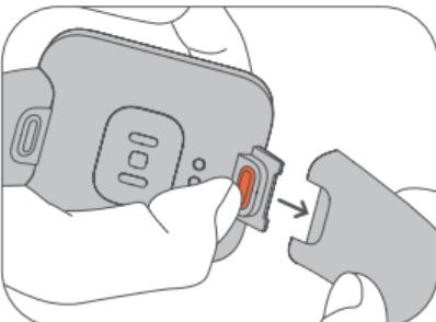
**Ponerse la correa:** Alinee la ranura de la correa con el reloj e insértela por el reloj hasta que oiga un clic.
