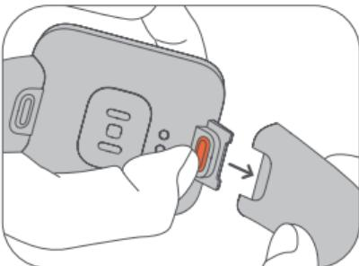
**Aanbrengen van het bandje:** breng de sleuf van het bandje in lijn met het horloge en breng het vervolgens aan in het horloge tot u een klik hoort.
